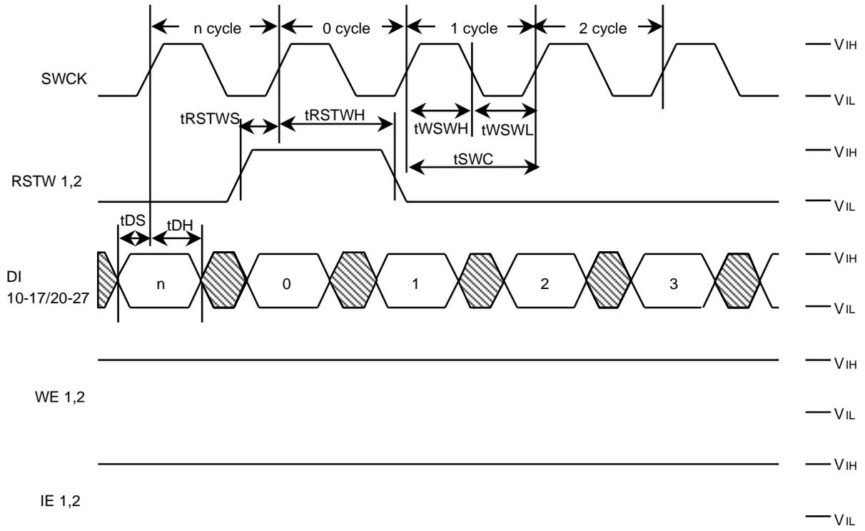
**Write Cycle Timing (Write Enable) : MODE1=Vss , MODE2=Vss**
