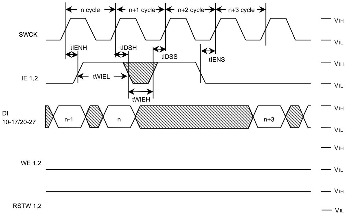
**Write Cycle Timing (Write Reset) : MODE1=Vss , MODE2=Vss**
