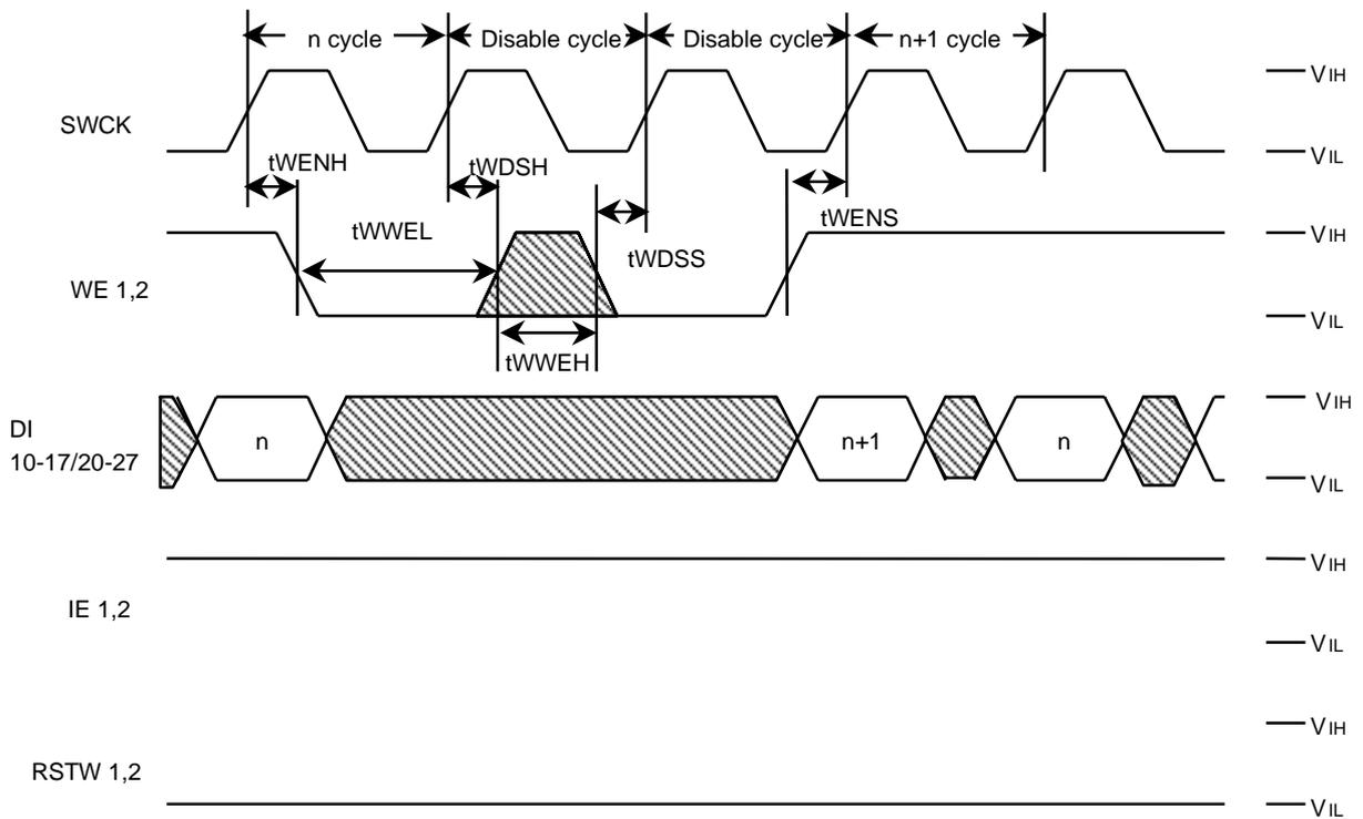
**Write Cycle Timing (Input Enable) : MODE1=Vss , MODE2=Vss**
