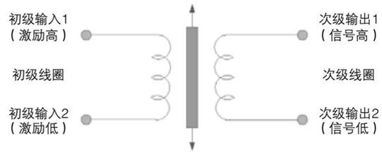
相位调整：当电在零点位置的衔铁向外时，具有供电电源的相位为输出。
