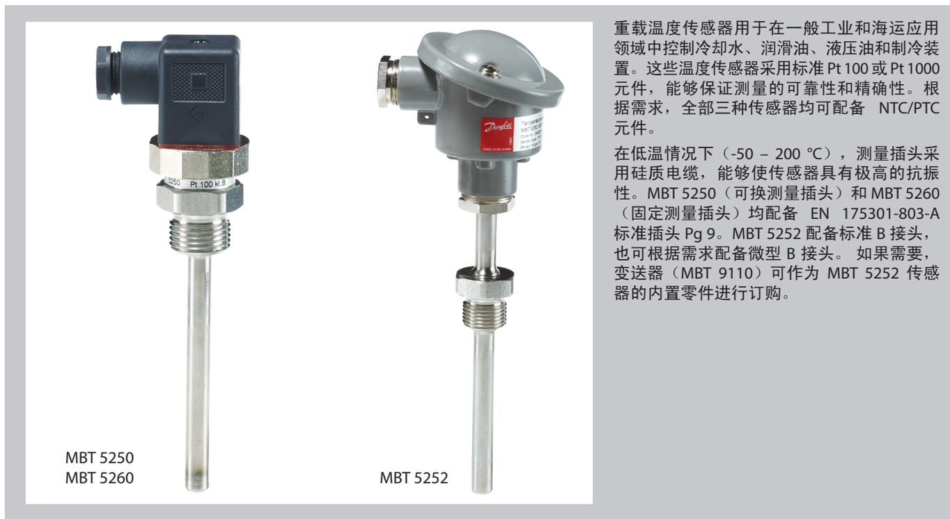
重载温度传感器用于在一般工业和海运应用领域中控制冷却水、润滑油、液压油和制冷装置。这些温度传感器采用标准 Pt 100 或 Pt 1000 元件，能够保证测量的可靠性和精确性。根据需求，全部三种传感器均可配备 NTC/PTC 元件。
