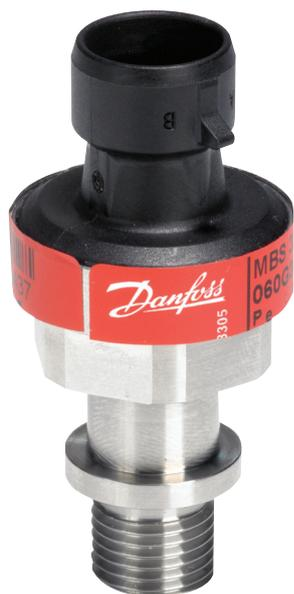
MSB 1900 型压力传感器专门为空气和水应用而设计，例如增压泵和空气压缩机。这款半柔性的压力传感器提供不同的输出信号、绝对或相对（表压）版本，测量范围从 0-4 bar 到 0-25 bar，提供多种多样的压力与电气连接。外壳材料为不锈钢 AISI 316L。
