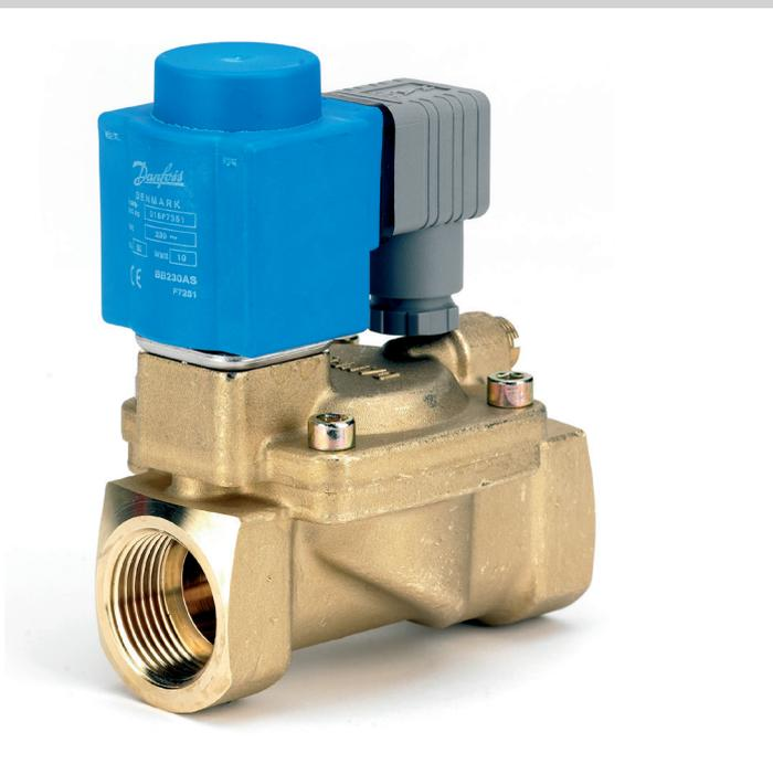
EV224B 是一种高压间接型2位2通先导式电磁阀，工作压力最高可达40巴，介质温度最高可达60℃，具有NC和NO型号。标准设置内置式先导过滤器，可更换平衡口，外壳防护等级达到IP67(视线圈而定)，确保稳定可靠和令人满意的功能。
