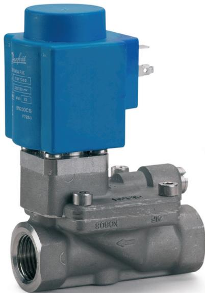
EV222B 是一种间接伺服式电磁阀，可以与受污染或腐蚀性介质连接使用。阀体为不锈钢材料，隔离式膜片防止螺线管系统进入杂质，内置先导过滤器，可更换平衡口，防护等级最高达 IP67 可确保可靠性和功能性。
