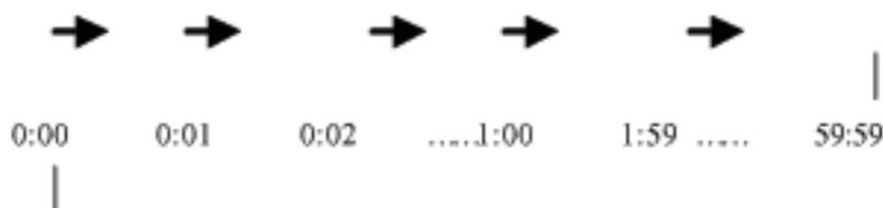
3. 正在正计时的过程中，按下任意键，计时停止，再次按下 Start/Stop 键，接着计时。
