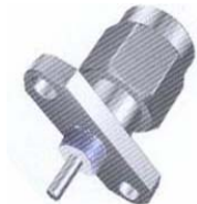
穿墙长度3mm 直径4mm 二孔法兰微带阳头
