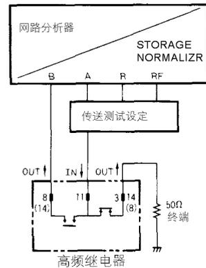
和测量无关的接点以 50 Ω 结束。
