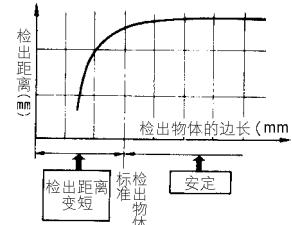
• 「大小和检出距离」的图,请用标准检出物体以上的大小设计。
