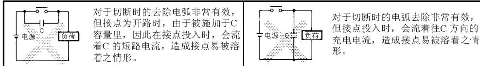
对于切断时的去除电弧非常有效，但接点为开路时，由于被施加于 C 容量里，因此在接点投入时，会流着 C 的短路电流，造成接点易被溶着之情形。
