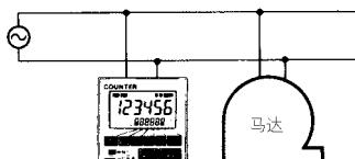
※没有输入输入信号却自己步进。
