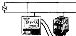
※有接点连接却没有步进。
