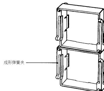
主体横向连续安装时，请将Y92F-30的成形弹簧夹转到上下两侧来配置。
