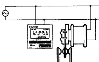
※没有输入输入信号却自己步进。
