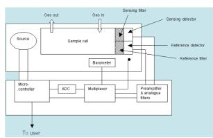
红外传感器监测透过4.26um波长红外光的强度,以此表示CO2气体的浓度,
